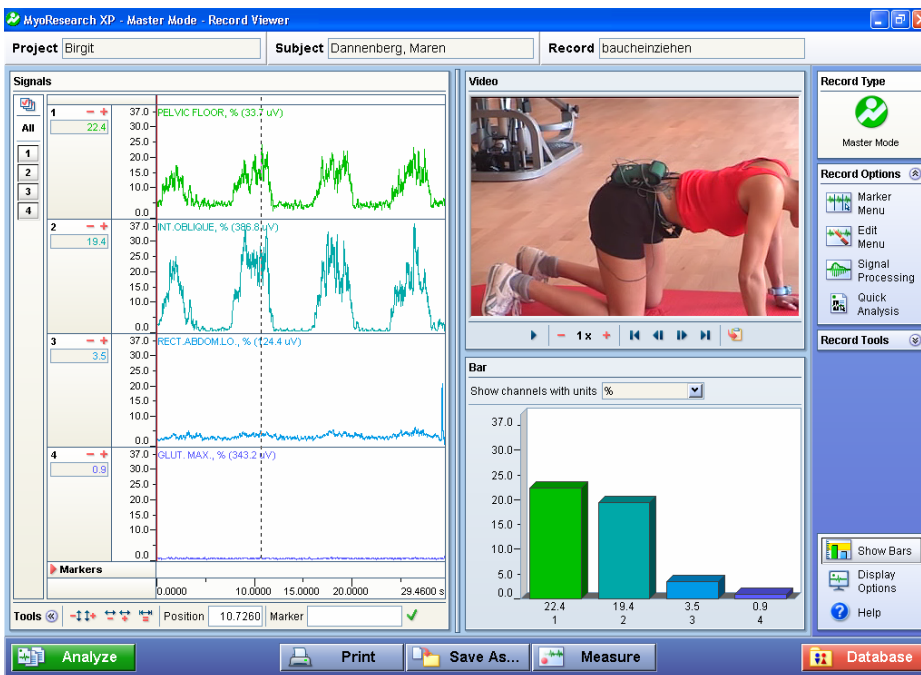
Grafik 8: Mehrkanal-EMG Aufzeichnung (linkes Fenster) mit synchronisiertem Digitalvideo (oberes rechtes Bild) und Echtzeitanalyse (unteres Balkendiagramm). Innerhalb dieser Abdominal Übung, wird ein hohes EMG für den Beckenboden und internal obliquus erreicht (Kap. 1-2), während die Aktivierung der globalen Muskeln niedrig gehalten wird (Kap. 3-4)
