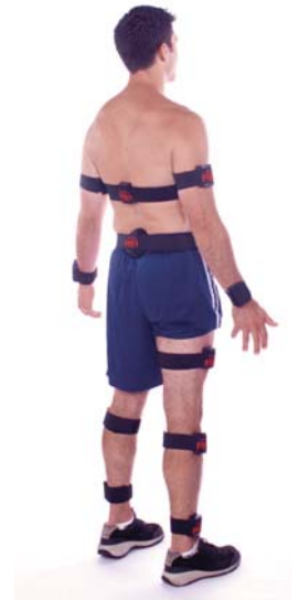
Testperson mit fixierten FAB-Sensoren
