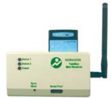
Mini-Receiver mit 8 analogen Input-Kanälen
