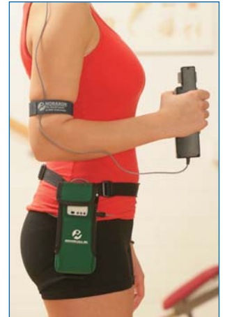
TeleMyo 2400 G2 Transmitter mit angeschlossenem Biometrics 2D Goniometer
