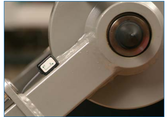
Der Akzelerometer am Hebelarm einer Gewichtstrainingmaschine montiert, nimmt Vibrationseffekte innerhalb der Achsenrotation wahr.
