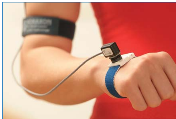
Indem eine spezielle Handbefestigung benutzt wird, kann der Akzelerometer ideal für Messungen bei Tremorpatienten eingesetzt werden.
